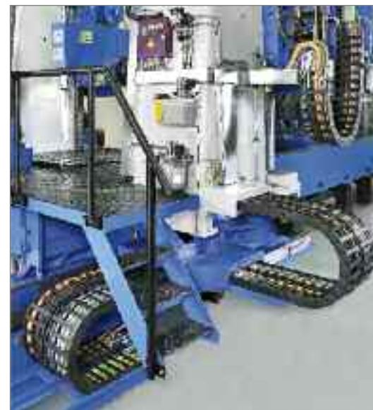
Cadenas portacables de la serie UNIFLEX y MONO en una fresadora de trébol de cilindros Fotos: Rottler Werkzeugmaschinen GmbH
