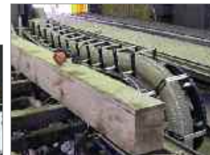
Sistema de portables QUANTUM en una máquina para mecanizado de madera
