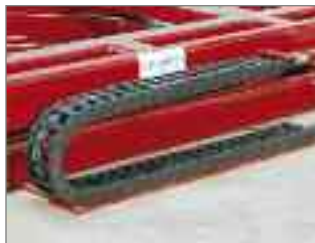
Cadenas portables de la serie UNIFLEX en una mesa elevadora de pantógrafo Fotos: Grunnei Hebetische Verladetechnik GmbH
