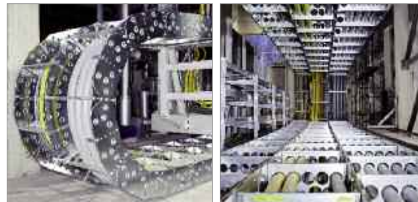
Cadenas portables de acero en una máquina del sector papero Fotos: Voith Paper Technology Center GmbH
