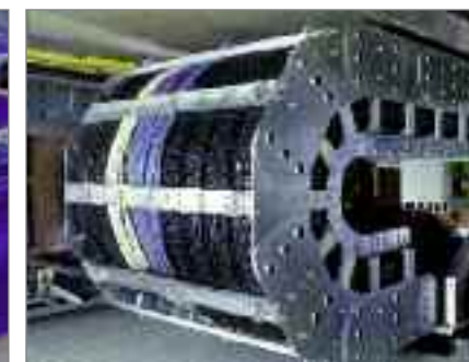
Portacables Serie MK 0475 para la separación de los cables en un portacables de acero Serie 3200 en detector ZEUS Foto: Deutsches Elektronen-Synchrotron, Hamburg
