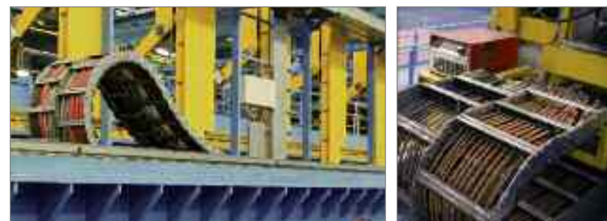
Cadenas portables de acero en una máquina de corte por láser Fotos: Meyer Werft GmbH
