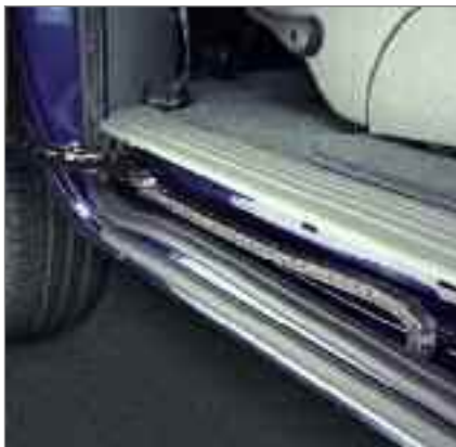
Cadenas portacables del modelo 0161 en una puerta corrediza de automóvil
