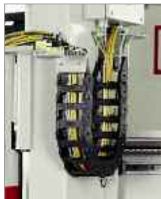
Portacables de la UNIFLEX-Serie en un centro de mecanizado CNC Fotos: Reichenbacher GmbH
