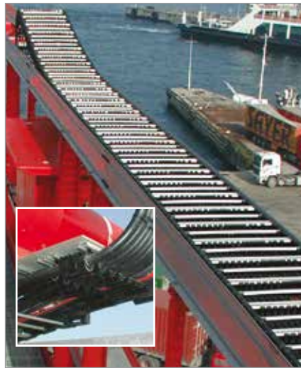
■ Cadena para grúa MC con paquete de cable, placa del punto móvil con sistema de bridas SZL y canal de guía de aluminio resistente al agua marina para su uso en todo el mundo en grúas portuarias
