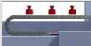
■ Portacables con carga adicional (cables y mangueras)
