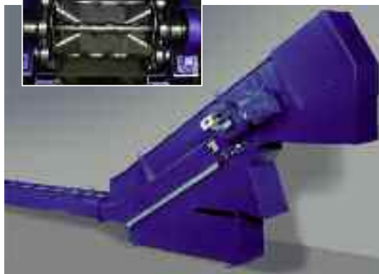
■ Cinta transportadora de charnelas desarrollada para la cortadora por láser TUBEMATIC de Trumpf. Las placas especiales de la banda impiden que el material a transportar se atasque.
