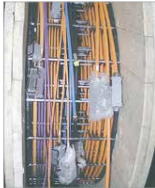
■ 125 m de recorrido: cadena completamente ensamblada con cables TRAXLINE Serie 700
