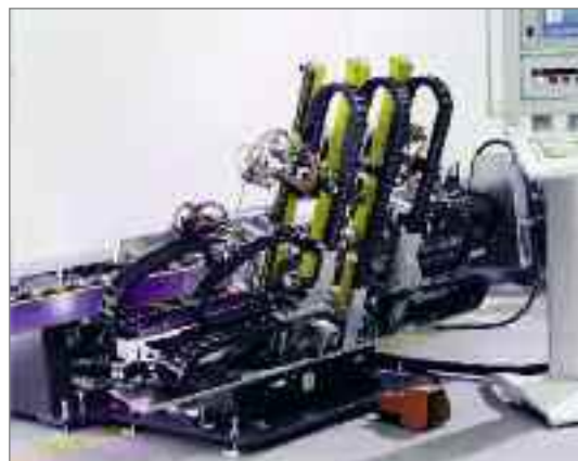
Portacables de la UNIFLEX-Serie en una estación de colocación de peldaños automática Fotos: Lenhard Maschinenbau GmbH
