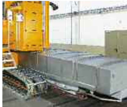
■ Cubierta telescópica en un torno
