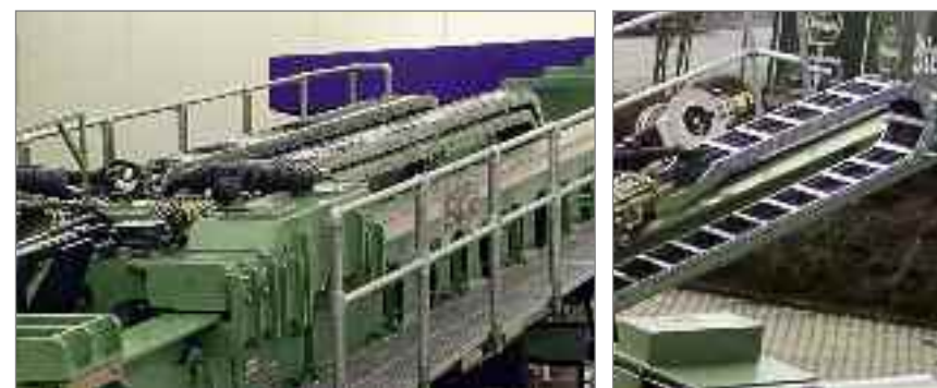
Portables en acero en una instalación de perforación Foto: Prime Drilling GmbH
