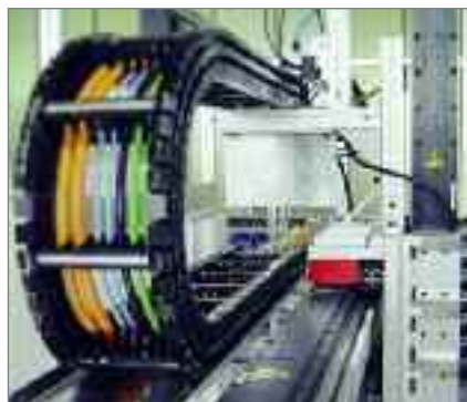
Sistema de portables QUANTUM en un sistema de manipulación
