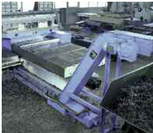
■ Cinta transportadora de placas charnelas en una mandrinadora-fresadora CNC
