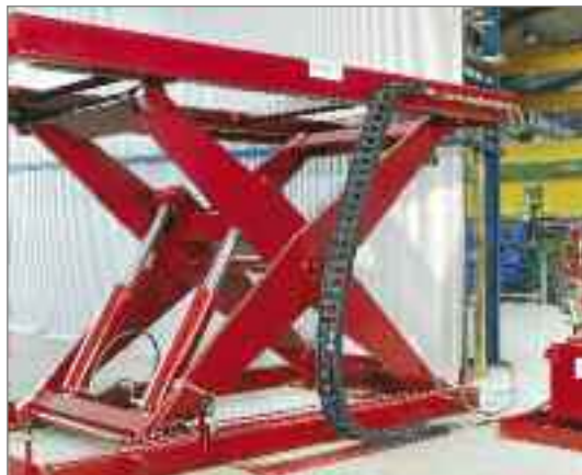
Cadenas portables de la serie UNIFLEX en una mesa elevadora de pantógrafo Fotos: Grunnei Hebetische Verladetechnik GmbH
