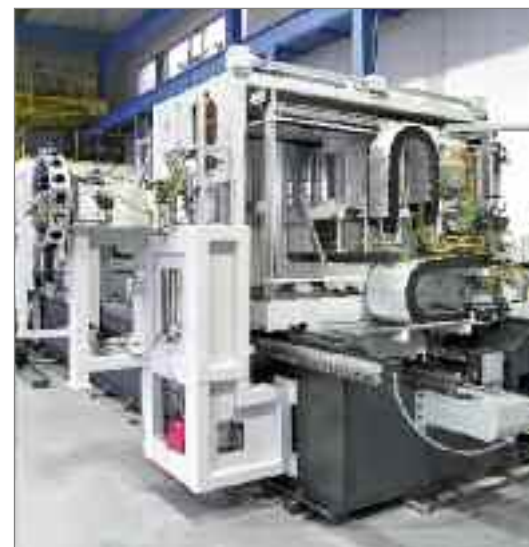
Cadenas portacables de la serie MASTER LT en una máquina de mecanizado de despuntes de tubos Fotos: Rottler Werkzeugmaschinen GmbH
