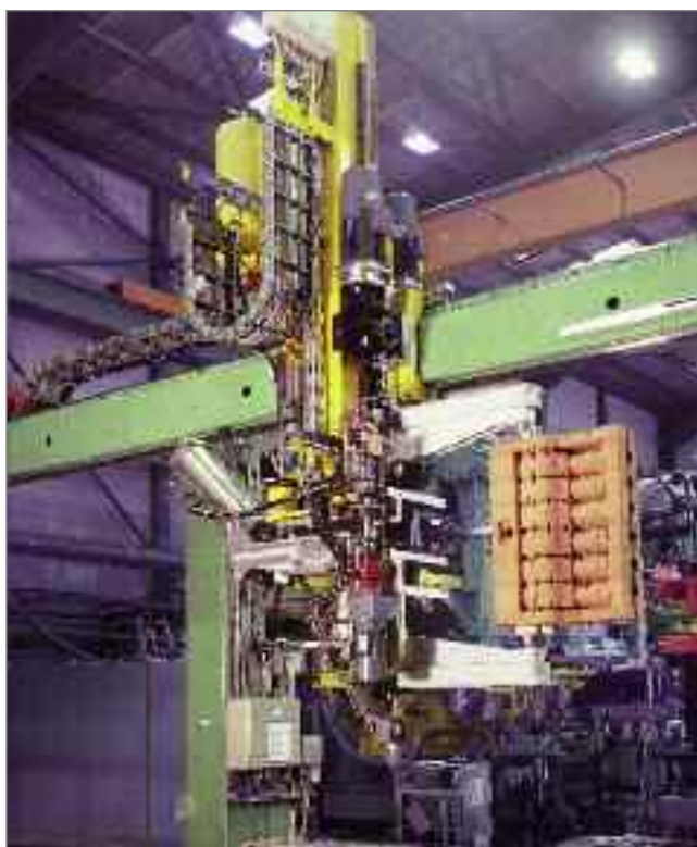
Sistema portables ROBOTRAX y portables en acero en un manipulador para la manipulación de moldes para fundición Fotos: Hottinger Maschinenbau GmbH
