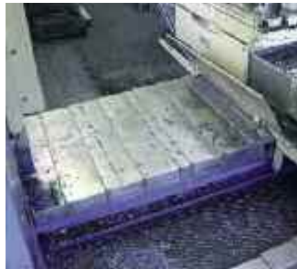
■ Cubierta telescópica con forma plana en una mandrinadora-fresadora
