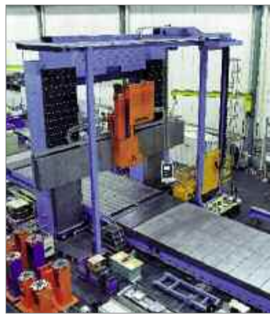
Cadenas portables en acero y plástico , así como cubiertas telescópicas de KABELSCHLEPP en una fresadora de pórtico Foto: Waldrich Siegen Werkzeugmaschinen GmbH
