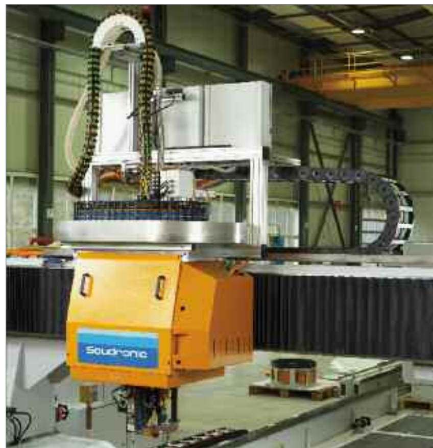
Portables ROBOTRAX, serie K y serie M en una cortadora láser Foto: Soudronic AG Automotive
