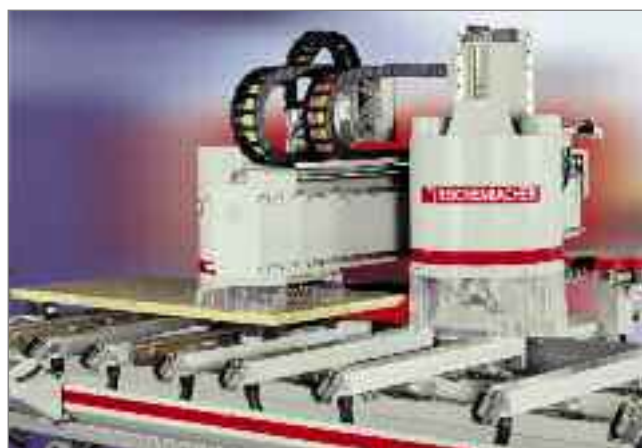
Portacables de la UNIFLEX-Serie en un centro de mecanizado CNC Fotos: Reichenbacher GmbH
