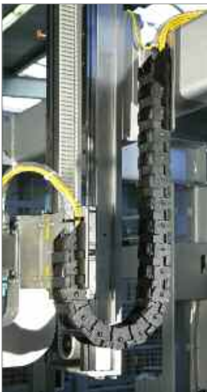
Portacables de la serie MONO y UNIFLEX en máquinas de embalaje Fotos: Transnova-Ruf GmbH
