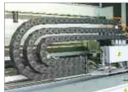
Sistema de portables QUANTUM en una máquina para mecanizado de madera
