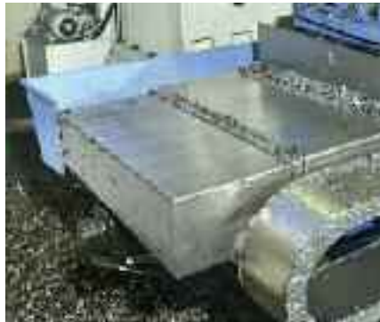
■ Cubierta telescópica en una fresadora
