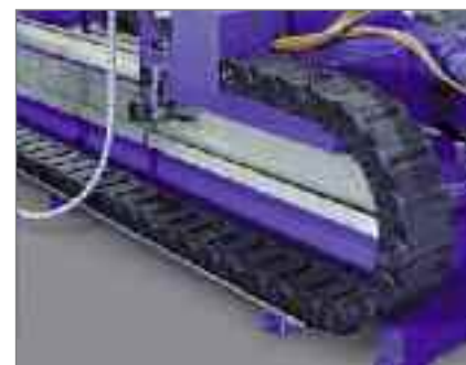
Portacables Serie MT 0950 en una rectificadora de cilindros Tipo de montaje: horizontal – "autoportante" Foto: Waldrich Siegen Werkzeugmaschinen GmbH
